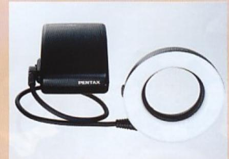
Dieses Blitzgerät ist speziell für Nahaufnahmen entwickelt. Es hat eine Leitzahl von 14 und besitzt vier Blitzröhren. Je nach Lichtbedingungen können nur zwei oder alle vier Röhren ausgelöst werden.
