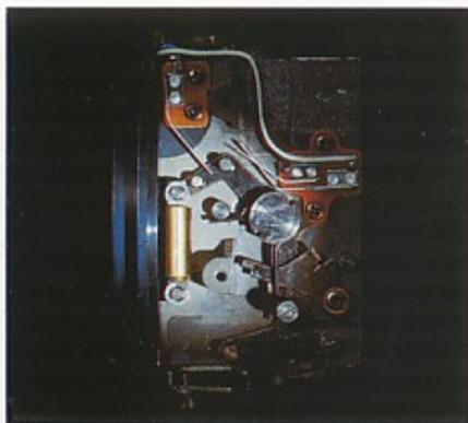
● Der pneumatische Stoßdämpfer der MX, der die Spiegelererschütterung auf ein Minimum reduziert.
