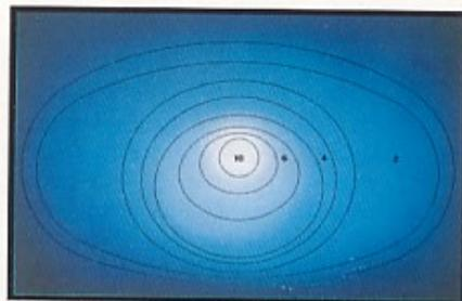
Die mittenbetonte Messung der MX. Die Linien bezeichnen den prozentualen Anteil der Fläche an der Messung durch die GPD's.
