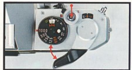
wird bei verriegeltem Auslöser verhindert, daß durch unbemerkten Druck auf den Auslöser der Belichtungsmesser eingeschaltet und unnötiger Strom verbraucht wird.
