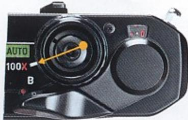
auf "100X" und fotografieren, wie in der Anleitung des jeweiligen Blitzgerätes beschrieben. Außerdem steht die "100X"-Einstellung noch für den Notfall zur Verfügung, so daß Sie bei Ausfall der Batterien immer noch mit 1/100 sec. fotografieren können. Zweckmäßig ist es auch, bei den Leerschwingen am Filmanfang auf "100X" zu stellen, bis das Bildzählwerk "1" anzeigt.
