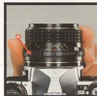
Bei Änderung der Blende durch Drehen des Blendenrings **A** ändert sich automatisch die Verschußzeit.
