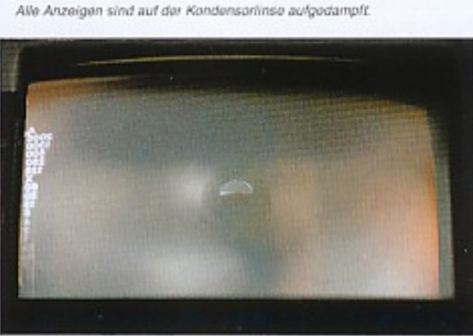
Alle Anzeigen sind auf der Kondensatorlinse aufgedampft.
