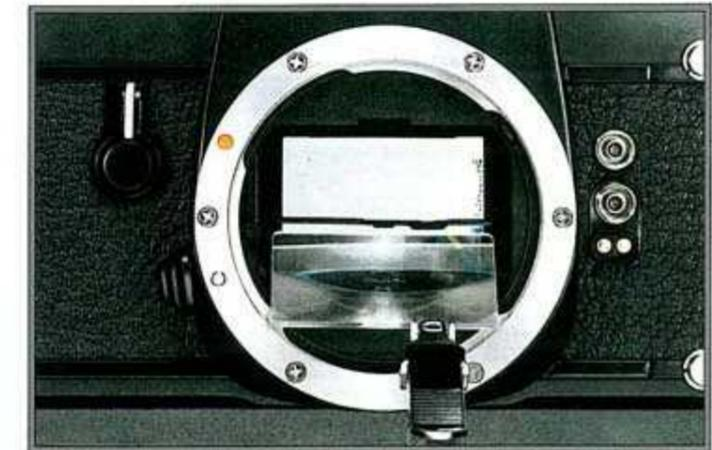
**SC-21** — Standard-Mattscheibe der LX mit zentralem Schnittbild-Indikator, umgeben von einem Mikroprismenring auf der Mattscheibe. Die drei Scharfstellmöglichkeiten machen sie zur universellsten der verfügbaren Mattscheiben. Für fast alle Objektive ideal.
