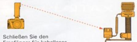
Schließen Sie den Empfänger für kabelloses Blitzen am Blitzgerät an.
