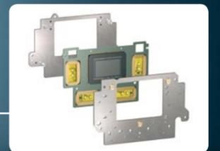
Die CMOS-Platte mit Elektromagneten zur Steuerung der Shake Reduction ist mit einem Metallrahmen mit Permanentmagneten als Einheit verbunden.
