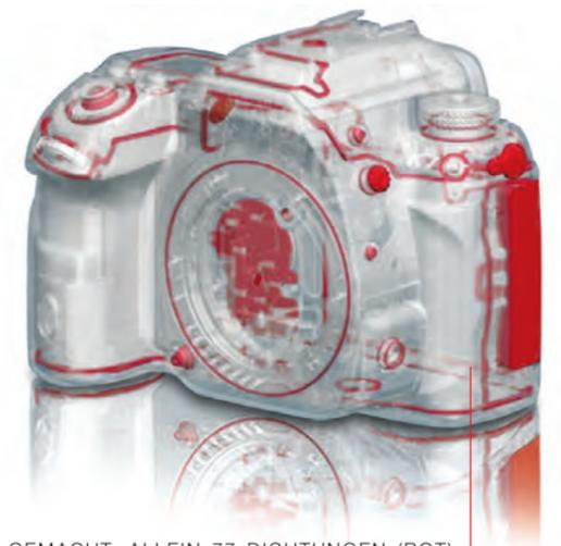
SICHTBAR GEMACHT: ALLEIN 77 DICHTUNGEN (ROT) AN DER KAMERA SORGEN IN IHRER GESAMTHEIT FÜR DEN SCHUTZ DER EMPFINDLICHEN INNEN LIEGENDEN OPTISCHEN UND ELEKTRONISCHEN BAUTEILE. AM BATTERIEGRIFF SIND ES WEITERE 43 DICHTUNGEN. UND SELBST DIE NEUEN OBJEKTIVE DER WR-SERIE SIND MIT 6 DICHTUNGEN GESCHÜTZT.
