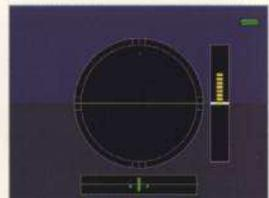
Im LCD-Monitor wird unten die horizontale und rechts die vertikale Lage der Kamera angezeigt.
